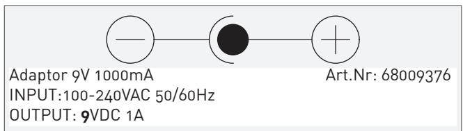
**POZOR!** Obratovanje je dovoljeno le s priloženim originalnim električnim napajalnikom ali originalnim nadomestnim delom. V nasprotnem obstaja nevarnost poškodb!
